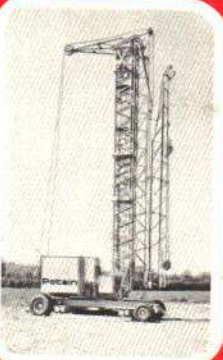
Dépliage de flèche dans 2 plans (Breveté)
