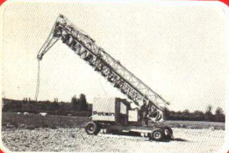
Relevage et télescopage automatiques
