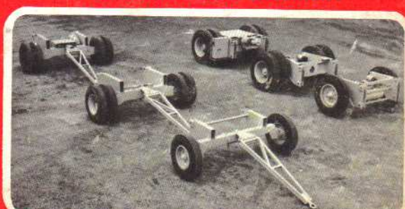
essieux amovibles pour 4-6 ou 8 roues et automoteur
